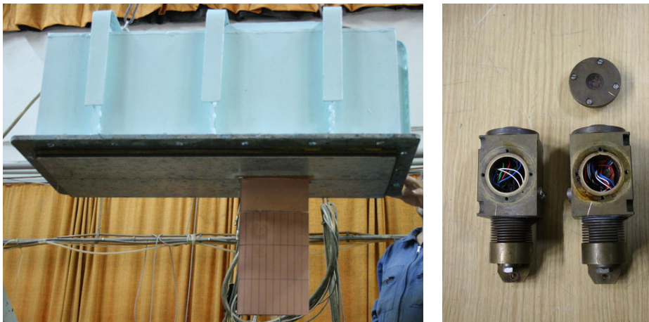
Figure 5.6. Photo de l'hydrofoil monté dans la balance (à gauche) et photo de deux boîtiers étanches des capteurs de forces (à droite)
