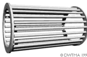
Figure 31 : Schéma d'un rotor à cage
